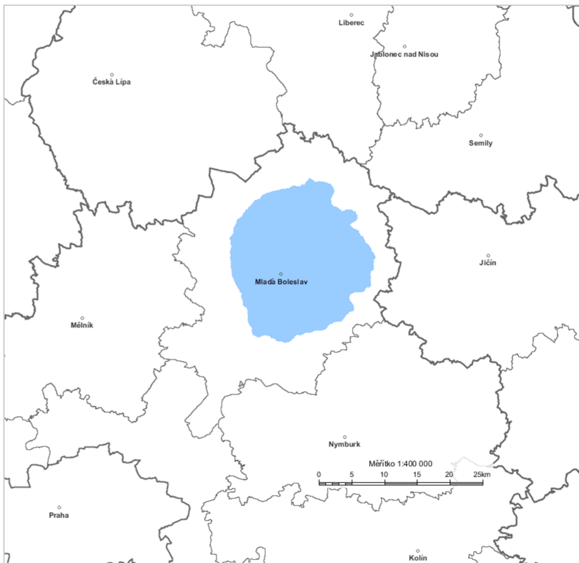
Diagram využití rádiových kmitočtů určených pro analogové vysílání v pásmu VKV pro vysílač MLADA BOLESLAV BRADLEC 103,5 MHz, stanovený výpočtem podle vyhlášky č. 22/2011 Sb. (modrá barva).
