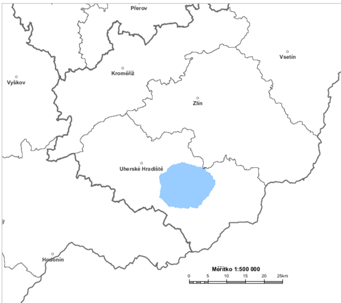
Diagram využití rádiových kmitočtů určených pro analogové vysílání v pásmu VKV pro vysílač UHERSKY BROD VODARNA 95,6 MHz stanovený výpočtem podle vyhlášky č. 22/2011 Sb. (modrá barva).
