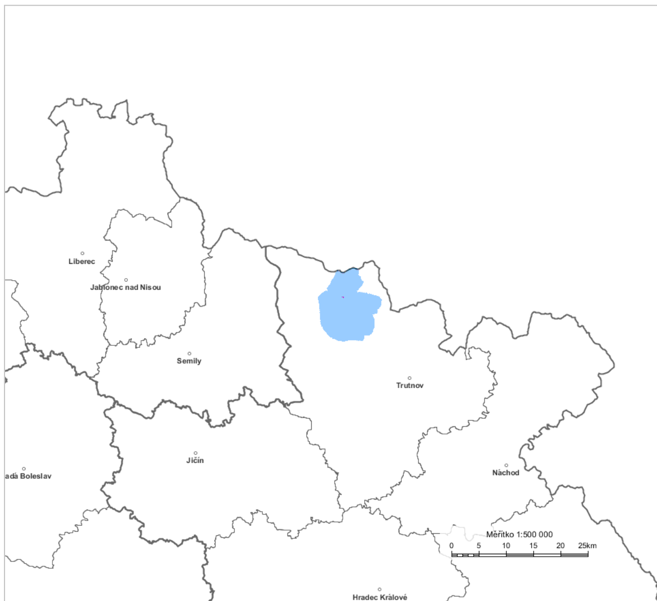
Diagram využití rádiového kmitočtu PEC P SNEZ HORIZONT 87,6 MHz stanovený výpočtem podle vyhlášky č. 22/2011 Sb. o způsobu stanovení pokrytí zemského rozhlasového vysílání ve vybraných kmitočtových pásmech – modrá barva.
