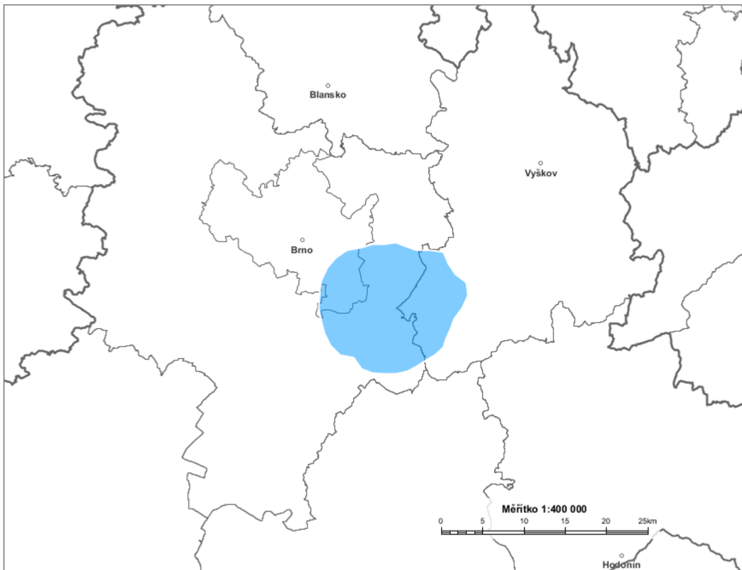
Diagram využití rádiových kmitočtů určených pro analogové vysílání v pásmu VKV pro vysílač MOKRA 2 89,2 MHz stanovený výpočtem podle vyhlášky č. 22/2011 Sb. (modrá barva).
